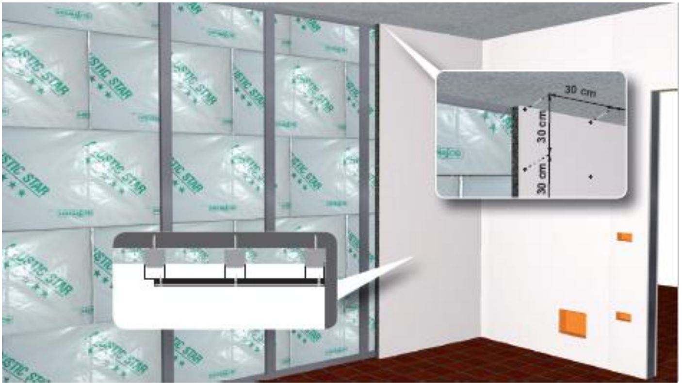
7) Zaskrutkovanie prvej vrstvy dosiek GESSFON.
