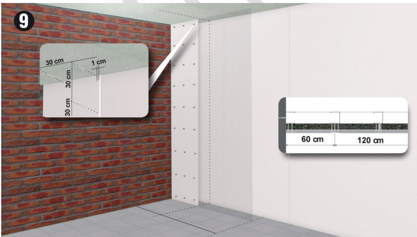
8-9. Ukončiť ukotvenie zvukovo-izolačnej dosky GESS FON.
